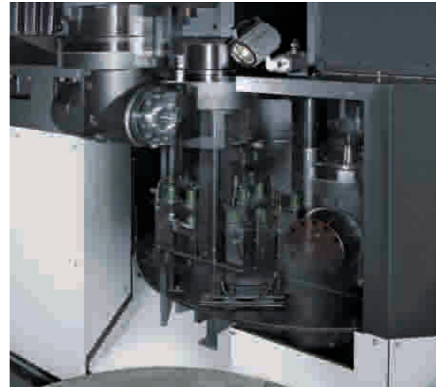
• Автоматическая смена шпиндельных головок: угловая токарная головка 90° с защитной крышкой
