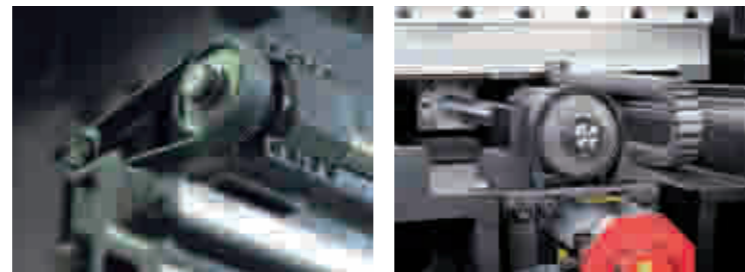
Механизм ограничения крутящего момента по осям X/Y/Z.
