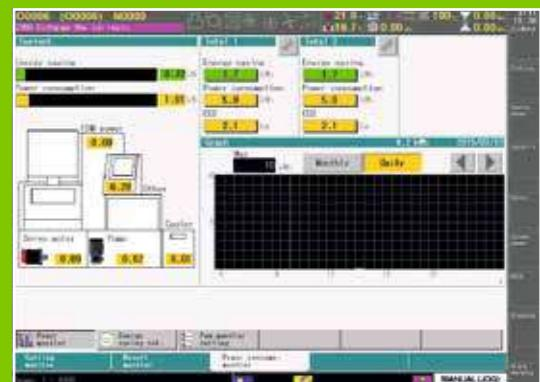
ROBOCUT позволяет с высокой точностью отслеживать количество энергии, потребляемое во время обработки и простоев. Кроме того, при необходимости возможна тонкая настройка режима энергосбережения: отключение промывки и насоса фильтрации, настройка отключения экрана, режим сна, автозапуск и автовыключение станка в заданное время.
