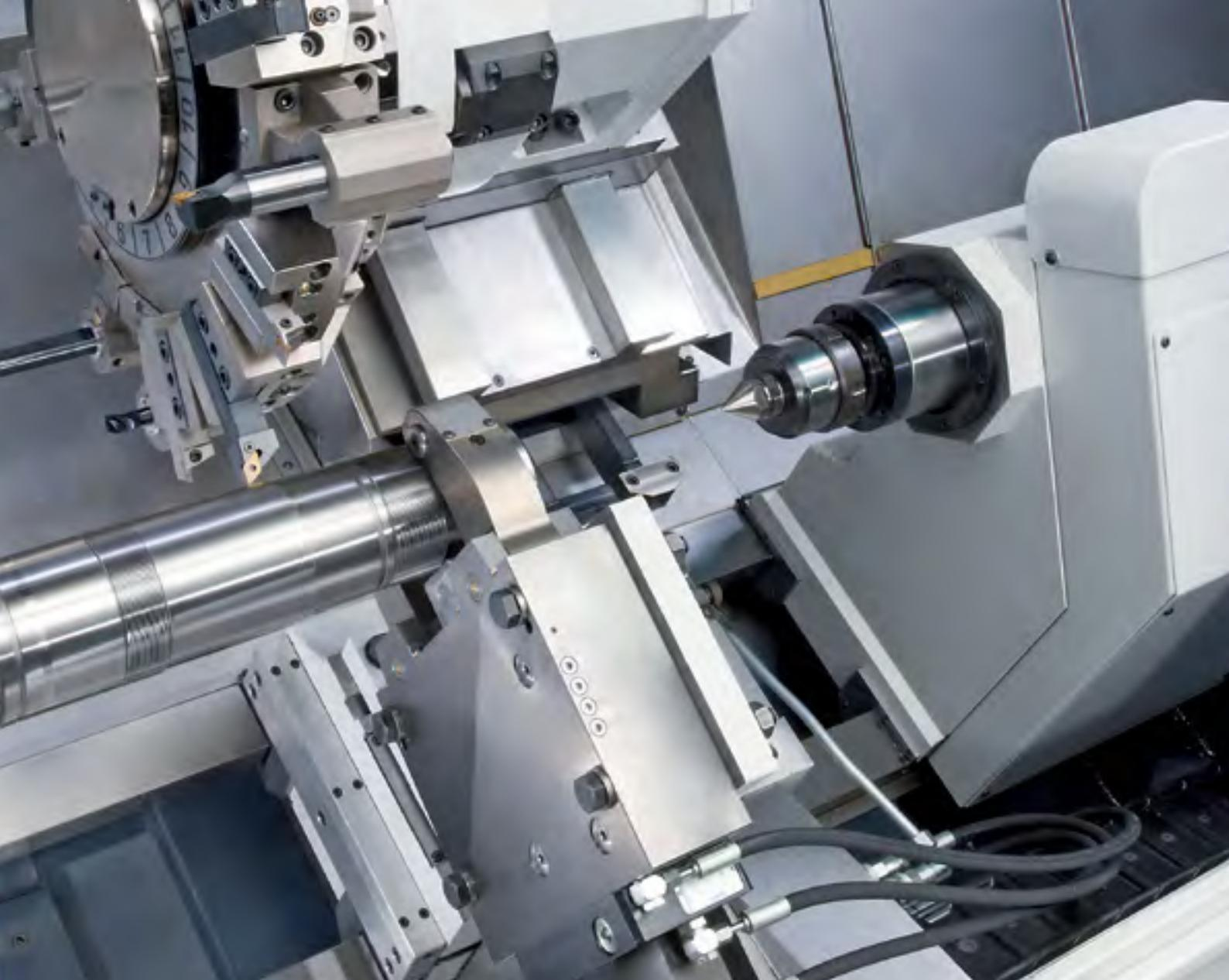
Станки В1250 и В750 оснащены одинаковыми револьверными головками и каретками по осям X и Y. Модель В1250 предназначена для обработки длинных прутков. Станок оснащен удлиненной станиной с продольным ходом 1310 мм и прочной автоматической ЧПУ-управляемой задней бабкой с гидравлической пинолью 115 мм. В1250 позволяет использовать неподвижные люнеты двух типов: с позиционированием за счет каретки по оси Z или с управлением двигателем по осям.
