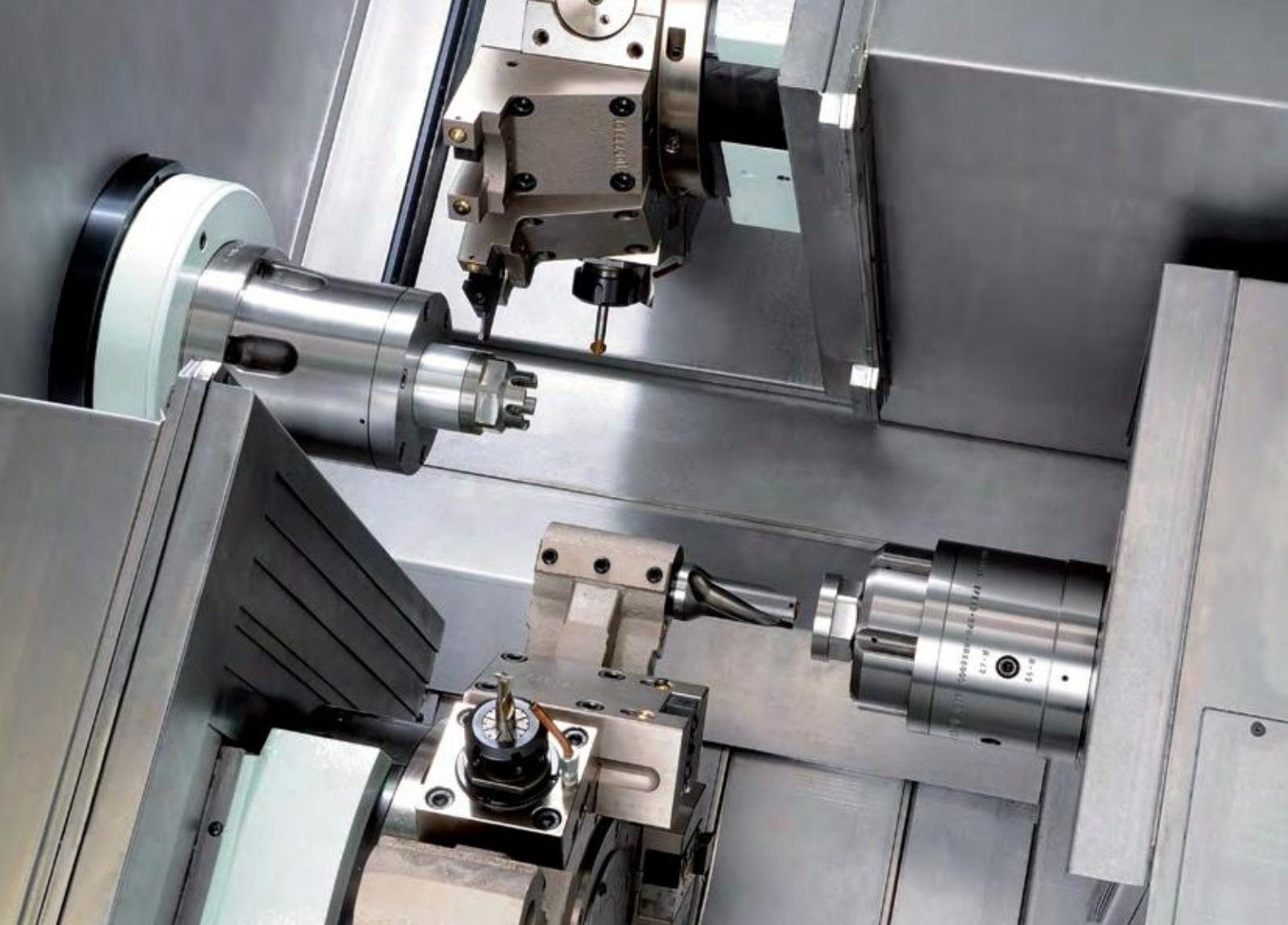
**Токарные центры с двумя шпинделями и двумя револьверными
