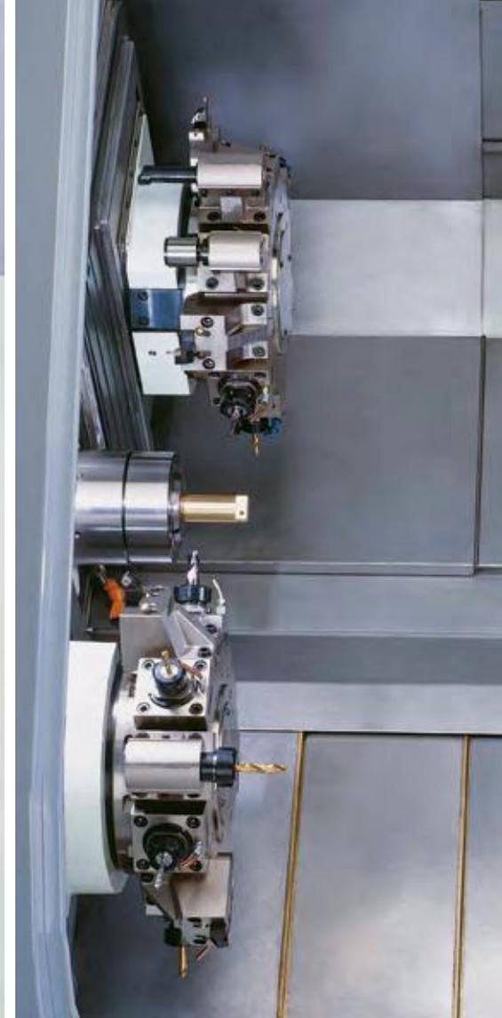
**Двухшпиндельные станки с тремя револьверными головками с высокой производительностью в обработке сложных деталей из**
