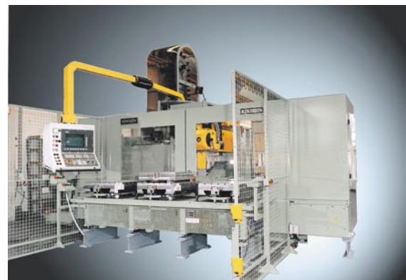
Paletten-Wechselsysteme mit unterschiedlichen Paletten-Größen ermöglichen das hauptzeitparallelen Rüsten.
