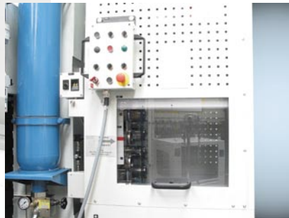
Das Werkzeugmagazin mit 30 bis zu 100 Plätzen lässt sich ergonomisch von hinten bestücken
