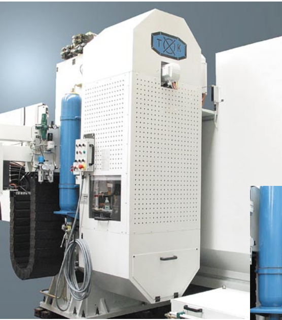
Das Werkzeugmagazin mit 30 bis zu 100 Plätzen lässt sich ergonomisch von hinten bestücken
