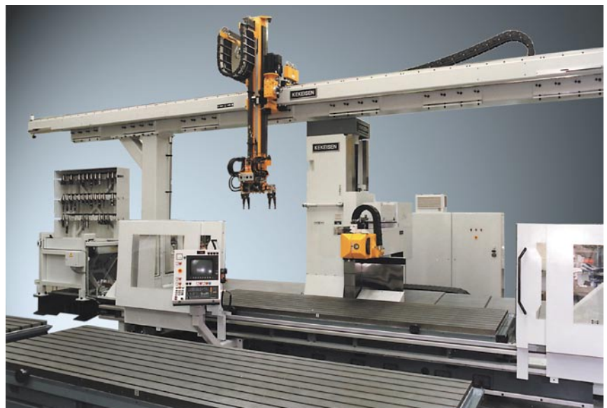
Paletten-Wechselsysteme mit unterschiedlichen Paletten-Größen ermöglichen das hauptzeitparallelen Rüsten.
