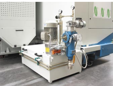
Kühlmittel-Einrichtung mit automatisch abreinigendem Filter
